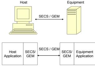
FIGURE 11-1: BASIC SYSTEM ARCHITECTURE
